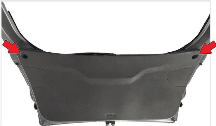
2 Отсоедините **разъем**, открутите **4 гайки** крепления, освободите **2 клипсы** и снимите наружную накладку крышки багажника.
