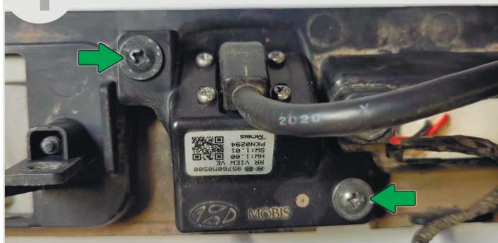
5 Открутите **4 винта** и снимите камеру со штатного кронштейна.
