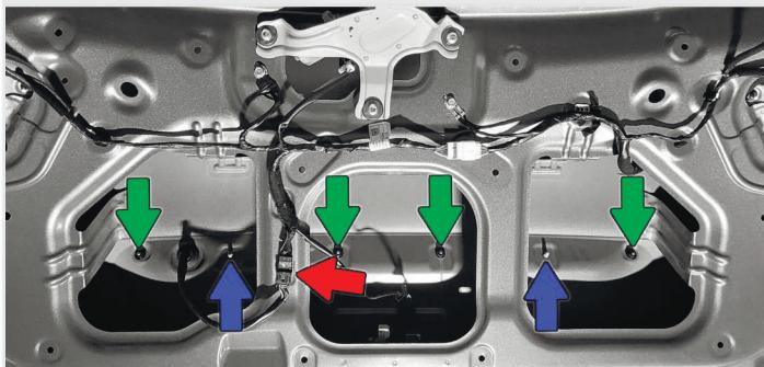
3 Открутите **4 винта**, освободите **3 фиксатора** и снимите нижнюю часть наружной накладки крышки багажника.
