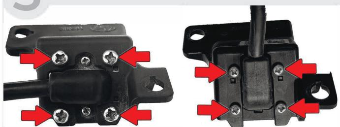
6 Установите камеру на новый кронштейн, закрутите винты крепления (для авто после 2020 года используйте **шайбы** из комплекта для 2-х винтов).
